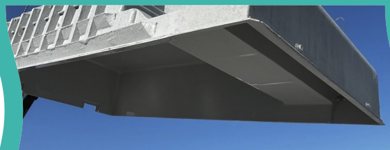
8. Démoulage & finition du bassin
